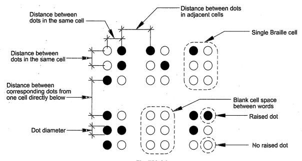
Fig. 703.4.3 Braille Measurement
